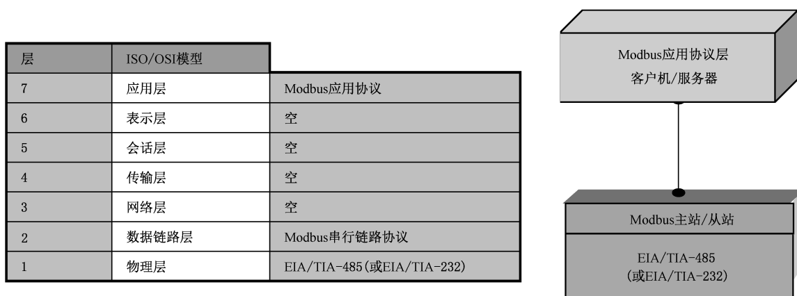
图 A.2 Modbus 协议和 ISO/OSI 模型
